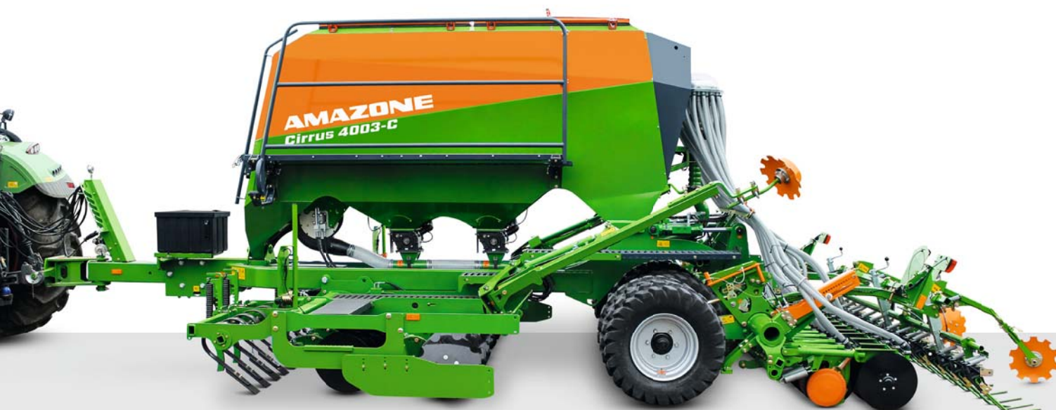
Cirrus 4003-C tlakovým zásobníkem na osivo a hnojivo s dvojitým dávkováním
