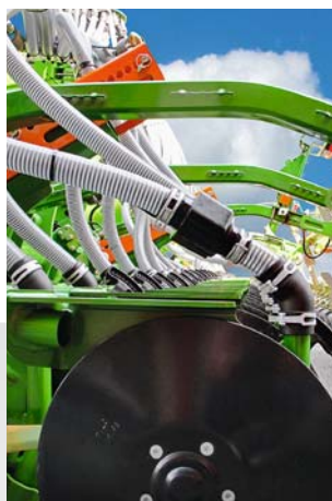
Senzor pro monitorování průtoku osiva na secí botce
