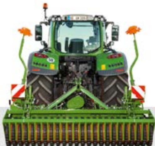
KG 3001 Super se znamená a klínovým válcem s profilem Matrix KWM 600
