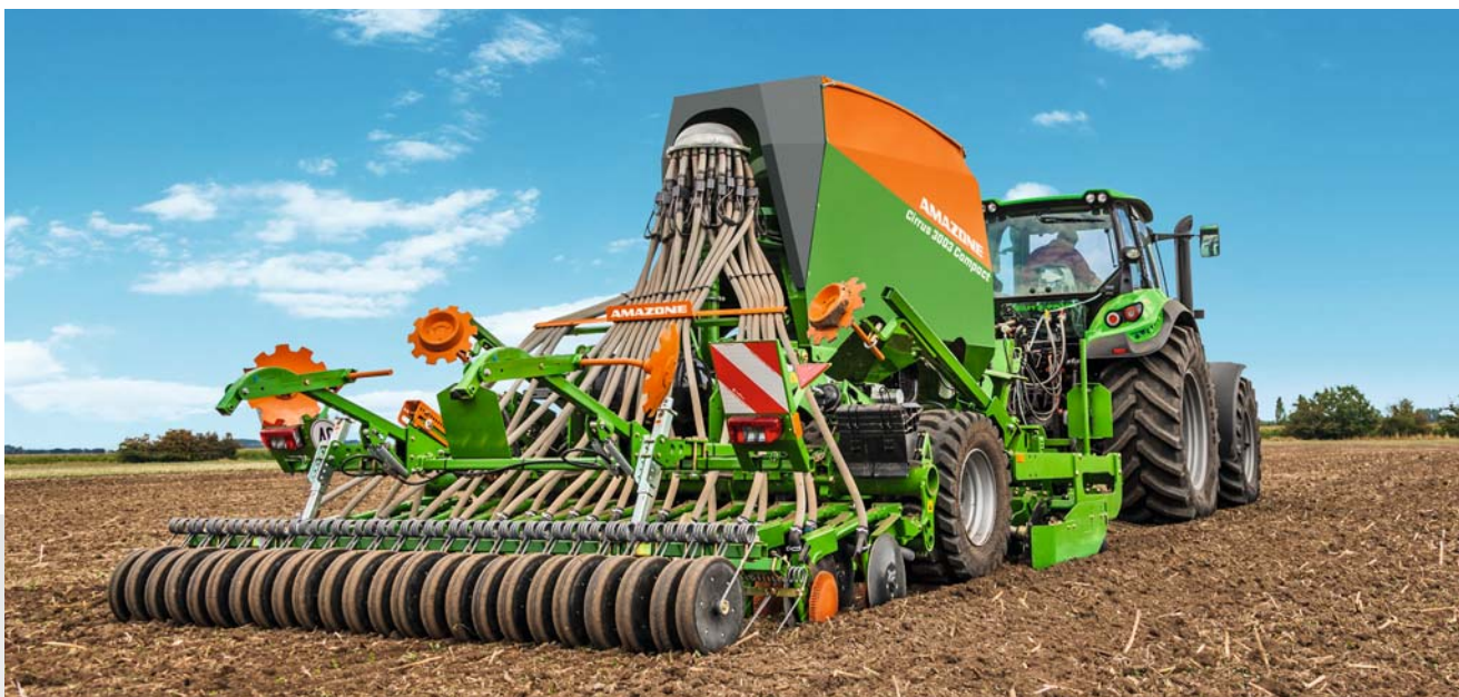
Cirrus 3003 Compact s botkami RoTeC pro a zamačkávacími kolečky
