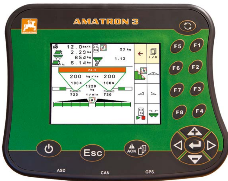
AMAZONE AMATRON 3 Velká obrazovka o velikosti 5,6"
