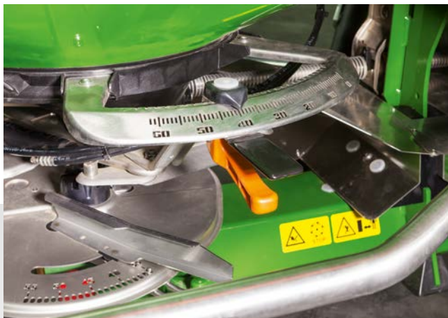
Stavěcí páka s velkou stupnicí
