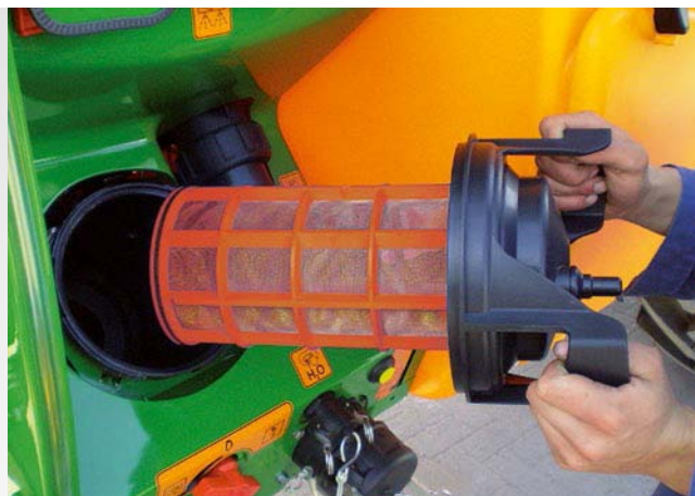
Sací filtr lze v případě naplněné nádrže otevřít, aniž by vytekl postřik.
