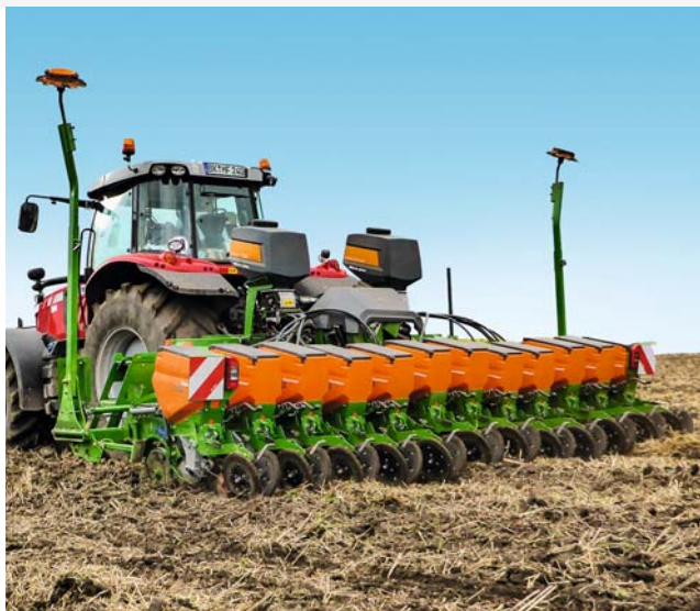
ED 6000 – 12řádek s dávkovacím zařízením na mikrogranulát Micro plus
