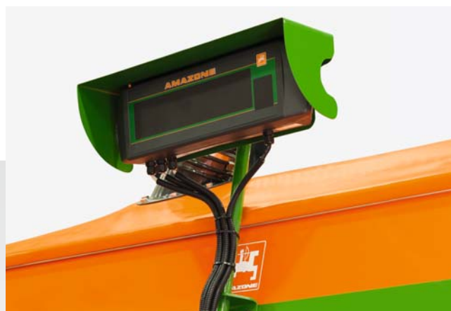
Vážící zařízení pro zadní zásobník na hnojivo u stroje ED 6000-2C Super
