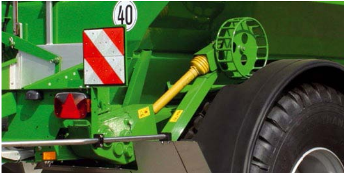
Doplňkové vybavení při osvědčení 40 km/h: co největší výstražná tabulka a robustní blatníky .
