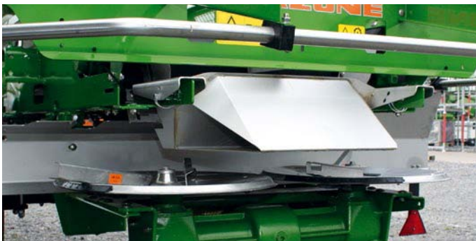
Robustní trychtýřový násypka – pro používání granulovaného hnojiva spolu s rozmetacími kotouči OM (ZG-B Special, ZG-B Super, ZG-B Drive).
