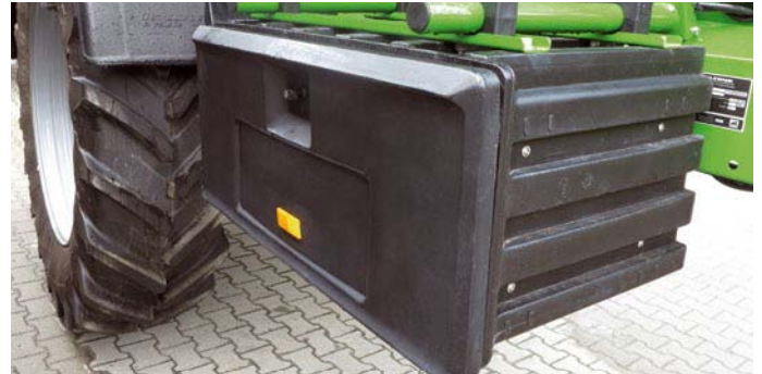
Do plastové přepravní schránky se přesně vejde mobilní zkušební souprava
